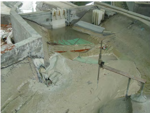
图 3 试验后河床淤积情况
