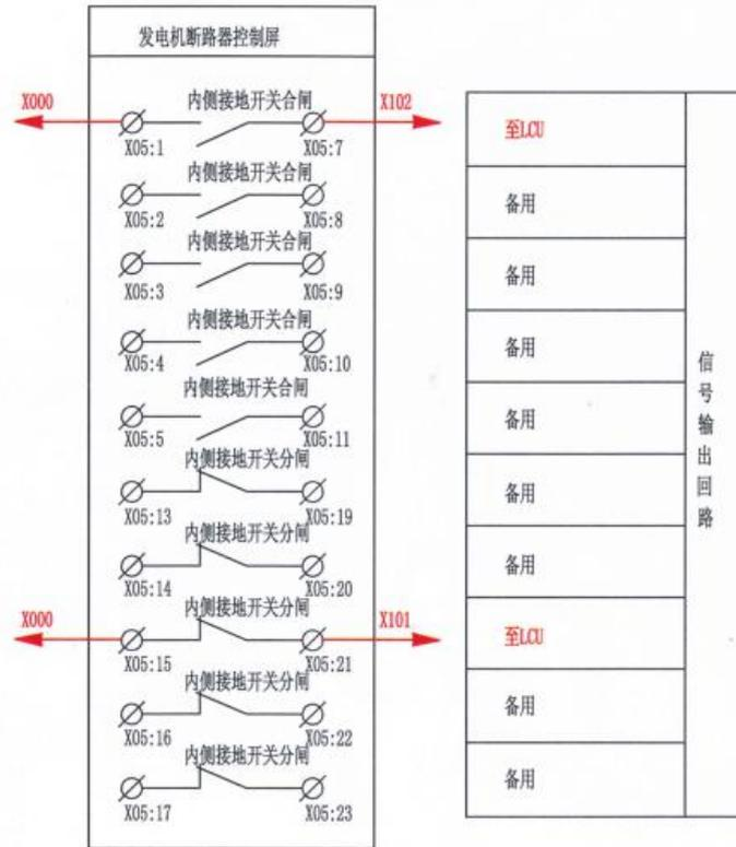
图 3 内侧接地开关接点上送回路
