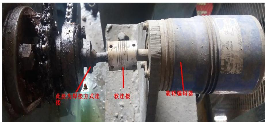
9#溢洪门旋转编码器与滚筒连接处结构
