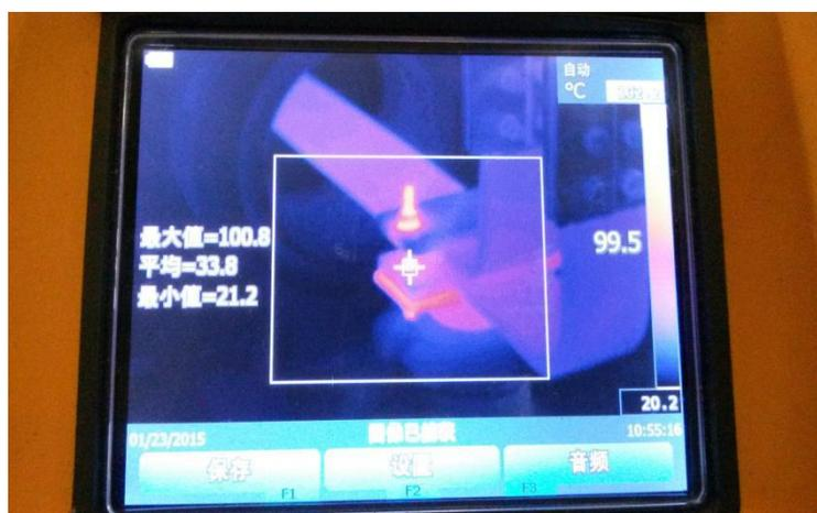
图14 某站7号机组中性点夹件温度测试
