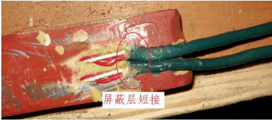
图 4 屏蔽层未裸露但内部短接 (3F 538 槽)
