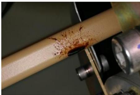
图 2 辅助绝缘拉杆放电图（一）
