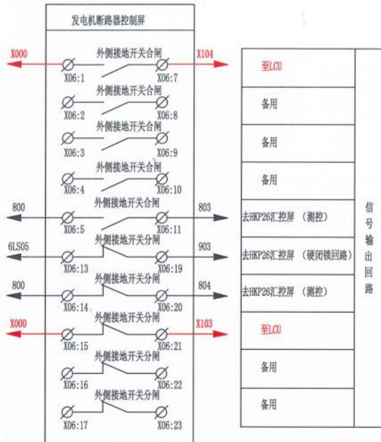
图 4 外侧接地开关接点上送回路
