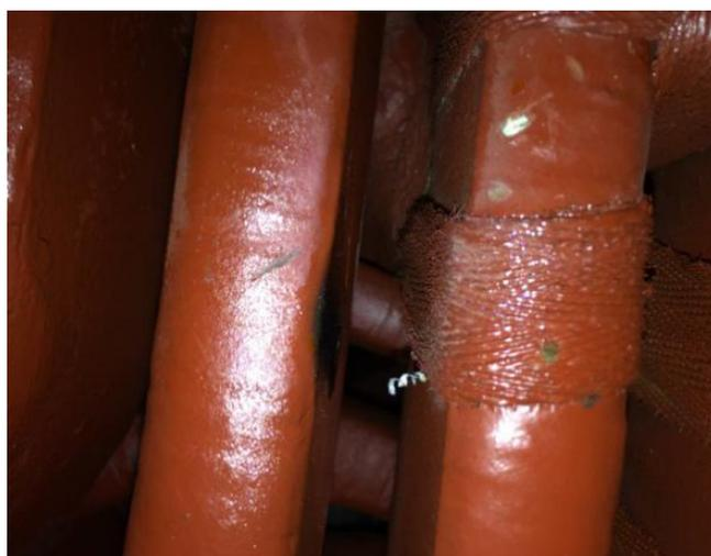
图 4 金属丝对绕组放电
