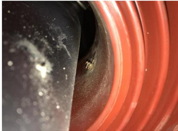
图 1 C 相烧毁的弹簧，未与导体接触
