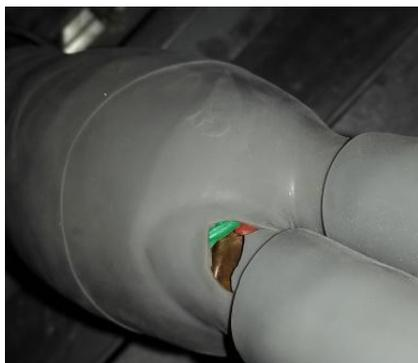
图 1 电缆冷缩头破损情况
