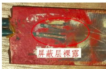
图 3 屏蔽层明显裸露情况（3F 501 槽）
