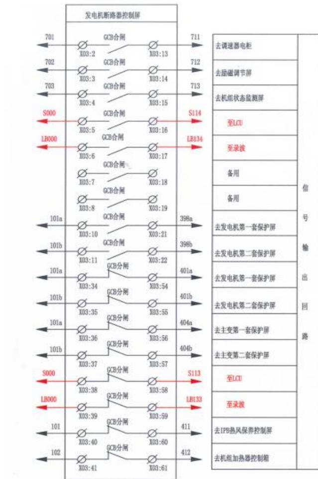
图 1 断路器接点上送回路
