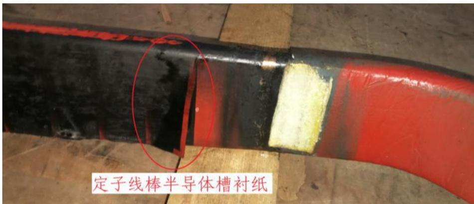
图 6 定子线棒半导体槽衬纸
