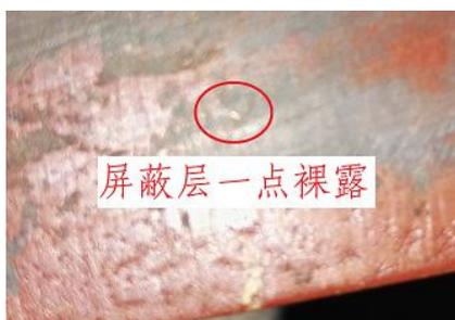
图 2 屏蔽层一点裸露情况（3F 505 槽）
